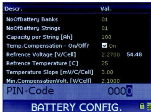
Fig. 26 - Inserimento PIN di configurazione batteria
