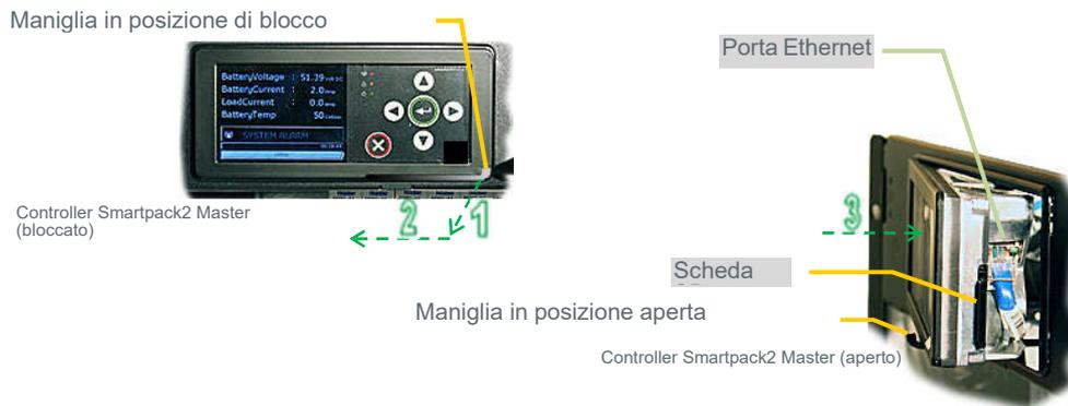
Fig. 3 - Apertura del controller Smartpack2 Master
