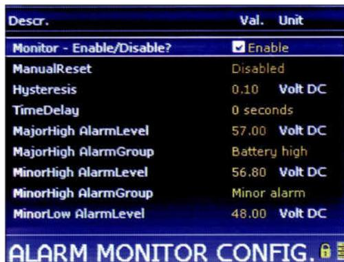
Fig. 29 - Abilitazione allarme tensione batteria
