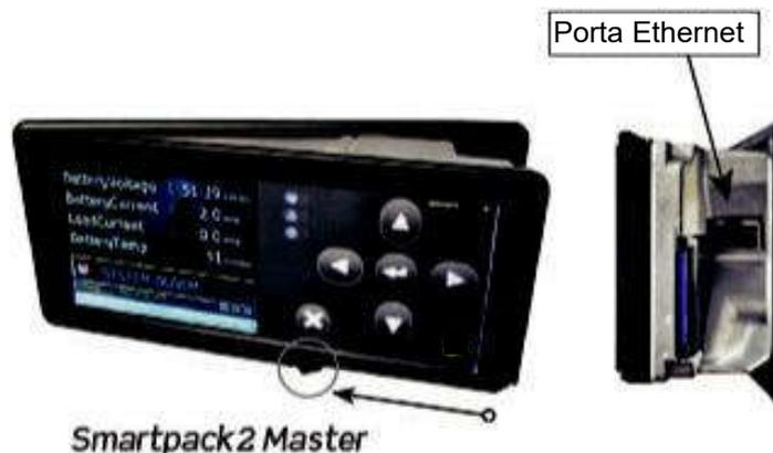
Fig. 4 - Porte Ethernet del controller
