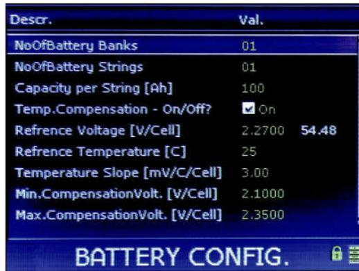
Fig. 25 - Configurazione della batteria
