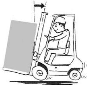
Per una movimentazione sicura, rispettare gli standard descritti dal Dlgs 81/2008 e successivi. Di seguito è riportato un esempio di movimentazione con carrello elevatore in sicurezza per cose e persone.
