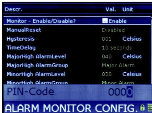
Fig. 19 - Abilitazione del monitor della sonda di temperatura
