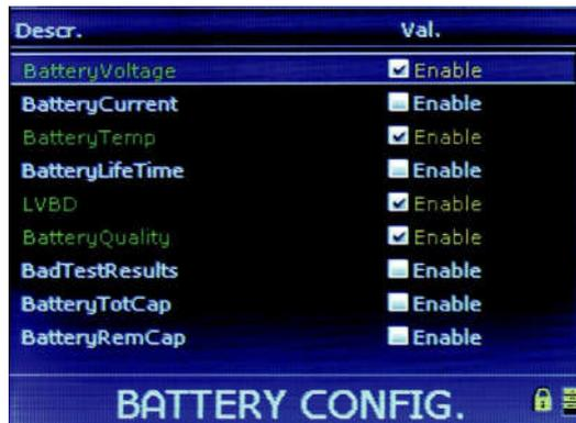
Fig. 28 - Abilitazione della tensione della batteria
