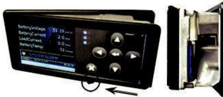
Fig. 38 - Display del controller master Smartpack2 e slot per scheda SD
