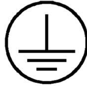
**TERMINALE DI MESSA A TERRA DI PROTEZIONE** Un terminale che deve essere collegato a terra prima di effettuare qualsiasi altra connessione all'apparecchiatura.
