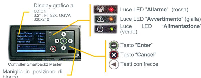
Fig. 2 - Tasti e indicatori anteriori del controller Smartpack2 Master
