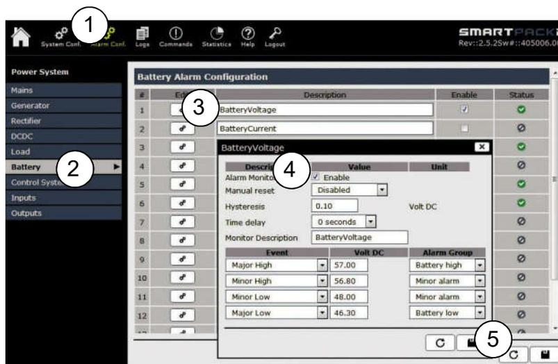
Fig. 27 - Configurazione allarme tensione batteria
