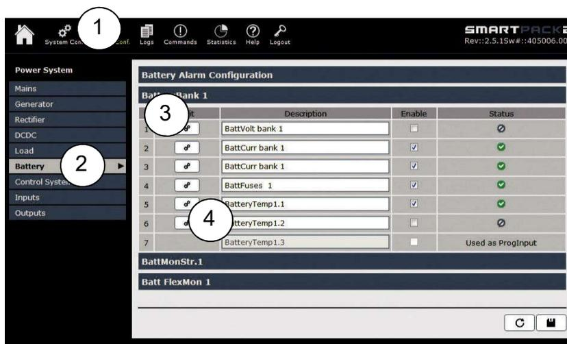
Fig. 14 - Impostazione della sonda di temperatura della batteria attraverso l'interfaccia web
