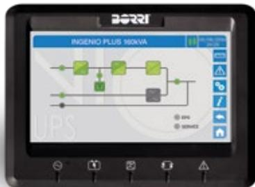
\*Touchscreen-Display optional bei USV von 60 bis 160 kW.
