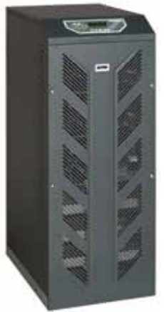
Serie B8000FXS, UPS 3/3 e 3/1 fase, da 10 a 100 kVA. On-line a doppia conversione, transformer free, tecnologia full IGBT, parallelabile fino a 600 kVA.
